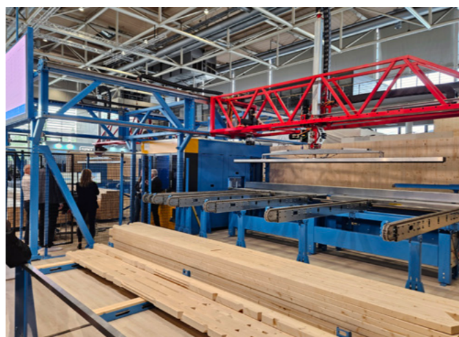
Una cella di produzione con sistemi di alimentazione e formazione di pacchi automatici rende possibile il taglio a CNC senza operatore
