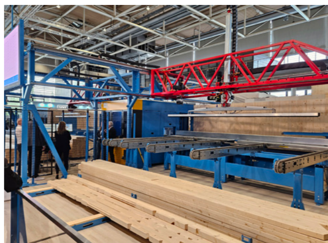
Une cellule de production avec chargement et colisage automatiques rend l'usinage CNC sans personnel possible
