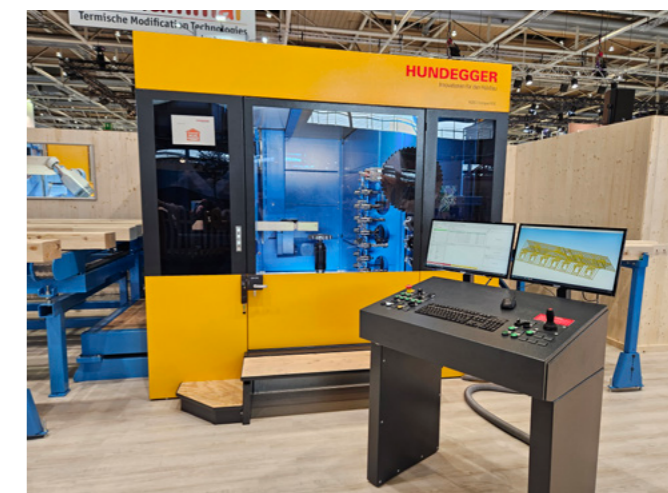
Avec la Robot-Compact 650 Hundegger met sur le marché une machine pour débuts en CNC très économe d'espace
