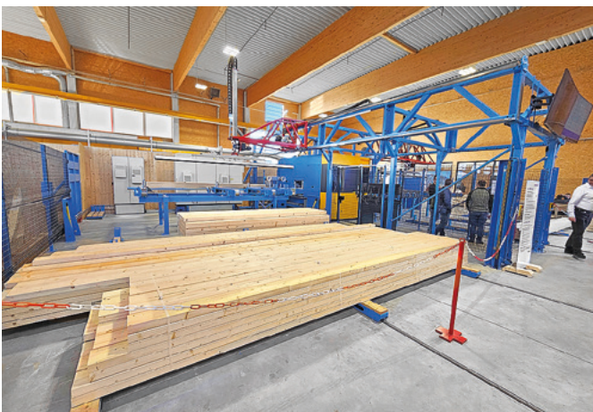
Die Zuschnittanlage Speed-Cut 480 verknüpfte Hundegger mit einer Pick & Feed-Beschickung und einer Pick & Place-Paketbildung
