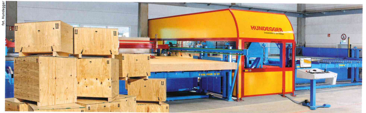
W zakresie produkcji wszystkich typów opakowań przemysłowych i eksportowych firma Hundegger przygotowała rozwiązanie bazujące na centrach SPM-2 i TURBO-Drive.
