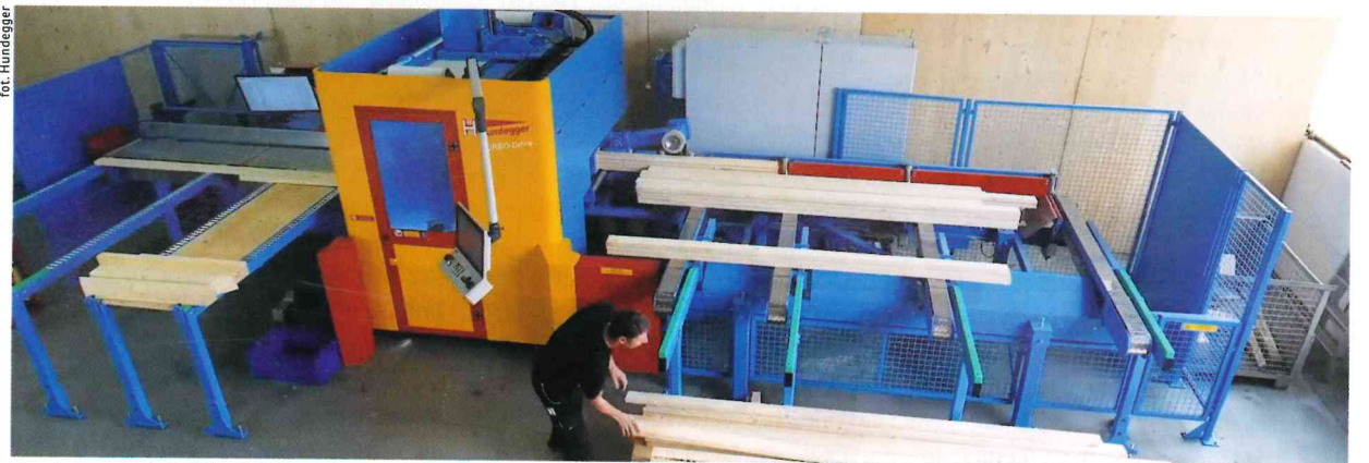
Zwarta konstrukcja TURBO-Drive daje doskonałą ochronę przed emisją pyłu i hałasu oraz może być zamontowana na posadzce hali produkcyjnej bez konieczności wykonywania jakichkolwiek prac budowlanych.
