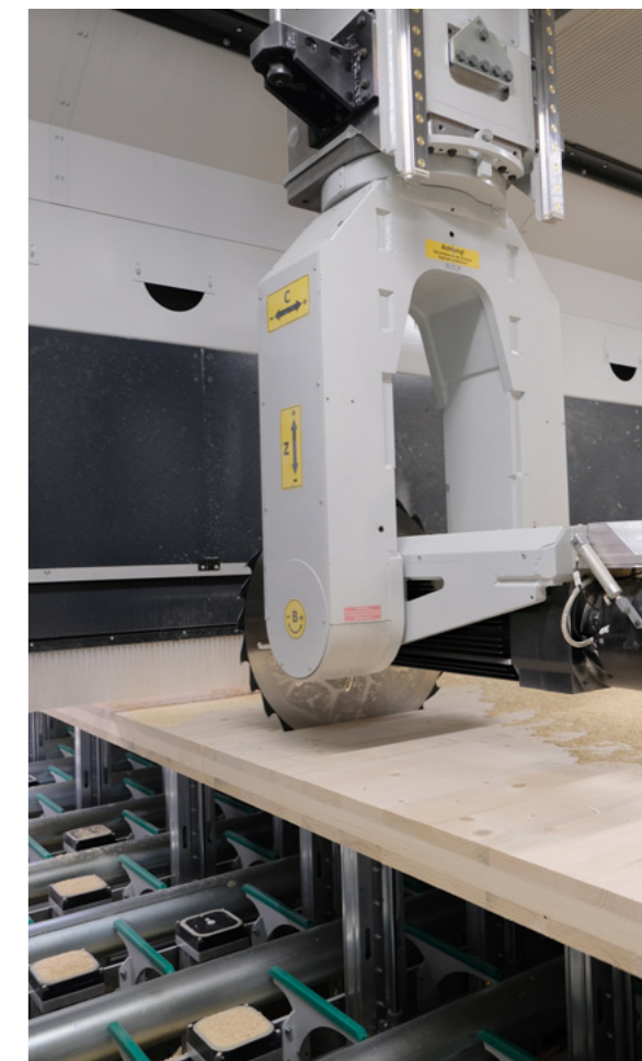
Il mandrino ad alta prestazione raffreddato ad aria garantisce la prestazione necessaria di taglio
