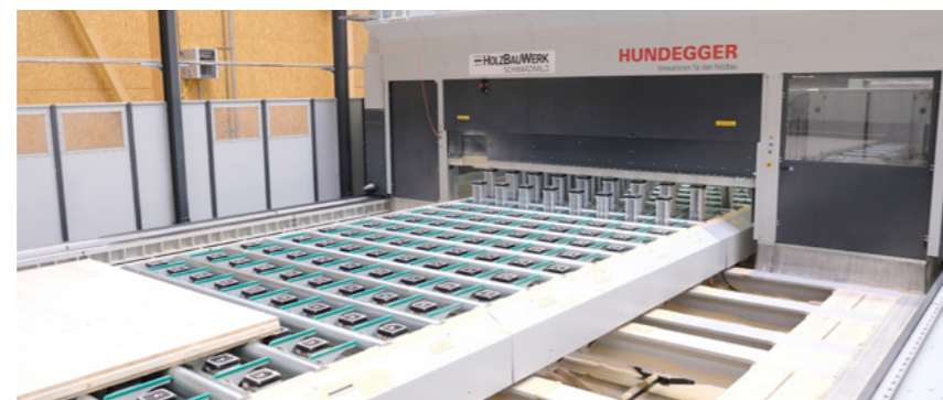
Per risparmiare tempo i pannelli sono trasportati dentro e fuori contemporaneamente. Quando i pannelli escono dalla macchina i singoli sollevatori a vuoto sono abbassati fila per fila e puliti automaticamente
