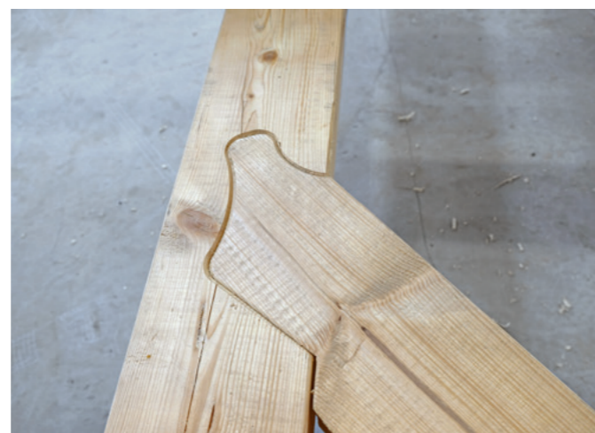
... ou cet assemblage complexe ne posent pas de problèmes pour la Robot-Drive
