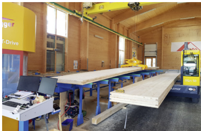
Mit der Robot-Drive kann Gerstenmayer Bauteile mit einem Querschnitt von 1300 mal 300 mm und einer Eingangslänge von bis zu 30 m bearbeiten
