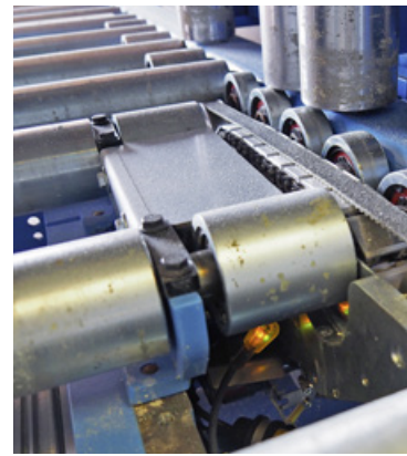
Die patentierte Messsystem HMC von Hundegger ist sowohl bei der Robot-Drive als auch der Speed-Cut SC3 im Einsatz
