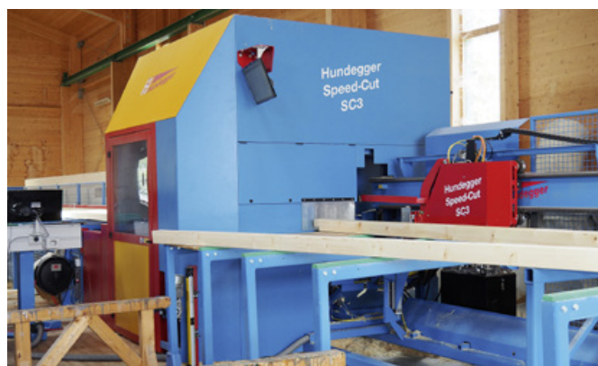
Der schnelle Zuschnittautomat: Die Speed-Cut SC3 sorgt für eine hohe Leistung bei PG Holzbau Service
