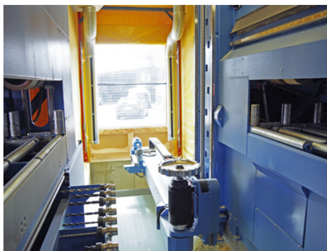
Robot-Drive mit Ausblick: Links und rechts vom Fenster befindet sich die Feinstaubabsaugung, vorne sind das Fräsaggregat und der Werkzeugwechsler
