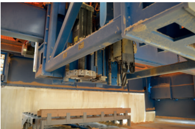
Umfangreiche Ausstattung: Die PBA verfügt über ein fünfschichtiges CNC-Aggregat mit Werkzeugwechsler
